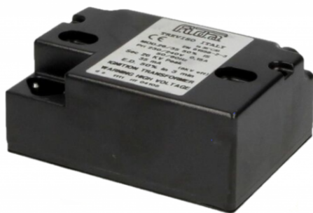
Transformateur électronique, 26KV, 30mA, primaire 230/240V, 50/60Hz,
