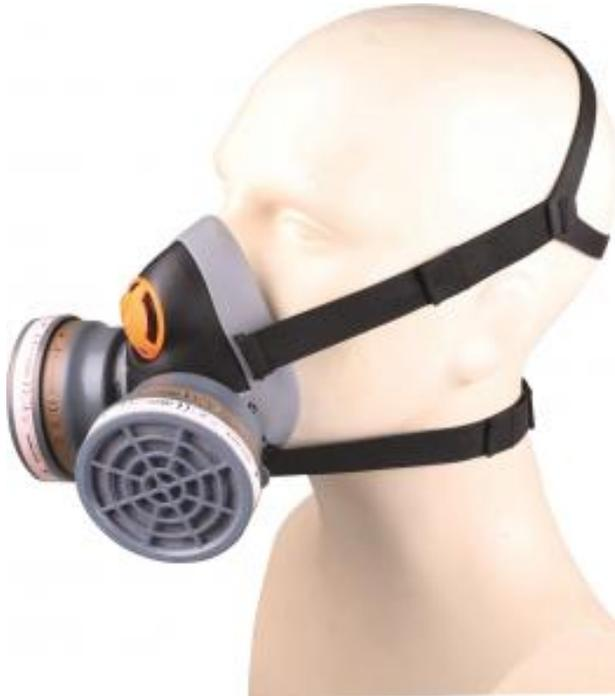
Demi-masque confort bi filtre : Corps du masque en polypropylène (PP) - Surmoulage thermoplastique (TPE). Equipé de 2 galettes filtrantes A2 et 2 pré-filtres P3. Lanières élastiques. Emballage sous blister.
